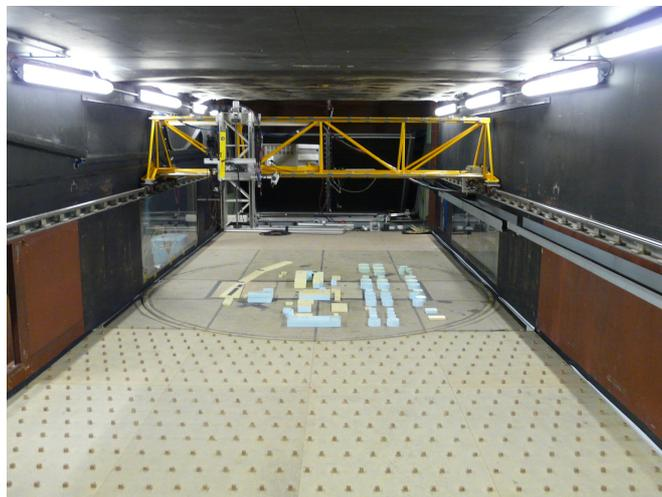
*Figure 97 : Chariot de mesure dans la veine d'essais*
